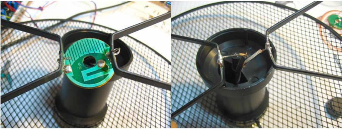
Au centre de la boucle se trouve un circuit imprimé d'adaptation que l'on peut aussi supprimer. Pour y accéder on décolle l'autocollant qui cache une vis centrale. Avec un bon fer à souder, on dessoude ce circuit pour raccorder le câble coaxial directement à l'antenne. Lors du remontage, on veillera à ne pas écraser le câble ni à le visser, tout en s'assurant que l'antenne est toujours orientable de 90°.
